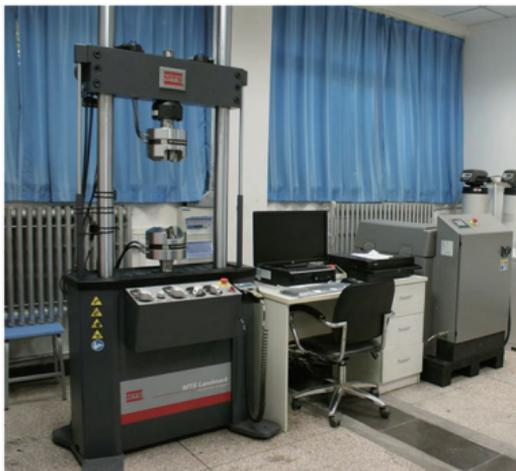
**主要用途：**液压伺服疲劳试验机能进行各种应力比 $r$ 的轴向、弯曲等疲劳试验，而且应力波性可以是正弦波、三角波、方波等，甚至可以输入模拟的随机波对小型构件施加模拟的随机载荷。它能进行载荷、应变、位移的自动控制。它也可以进行静强度试验
