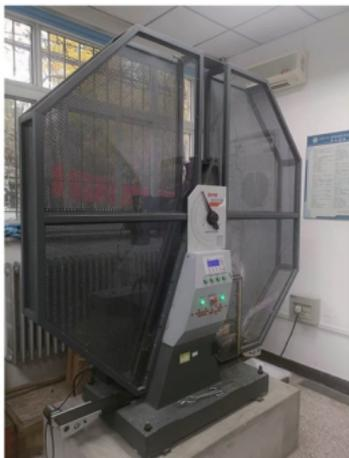
**主要用途：**冲击试验机用于测定材料的冲击韧度
