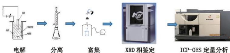
**物理化学相分析方法**，是利用析出相和基体的电化性质差别，通过电解将基体溶解而析出相以沉淀形式保留，消除基体干扰，将得到的混合析出相分离富集，准确分析析出相的类型、含量和组成。
