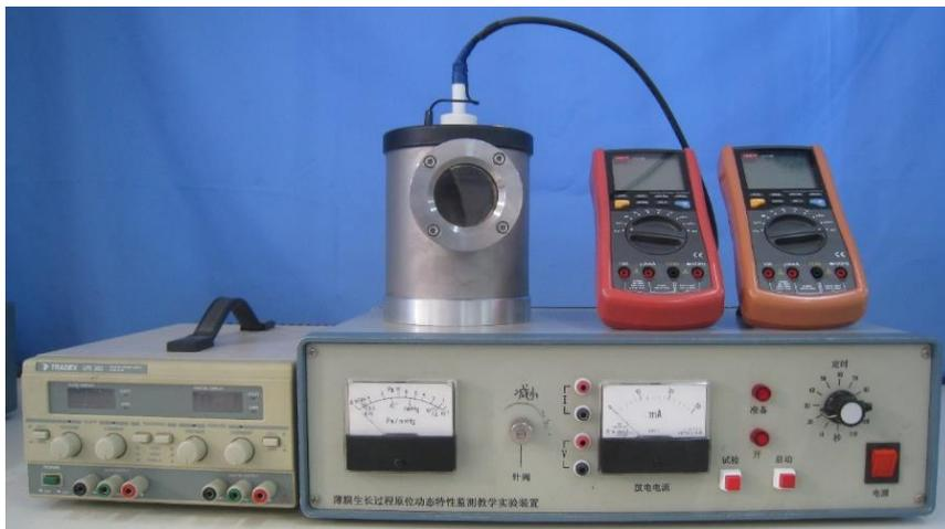
利用离子溅射在较低真空度下实现金属薄膜制备，采用四接头低电阻恒流测量方法，原位测量薄膜电阻随沉积时间变化规律，反应薄膜形成“成核、网状、导通、连续”过程变化趋势，清晰描述微观薄膜物理性能与薄膜生长过程的对应关系。
