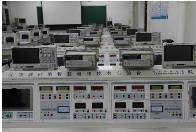
我中心教师自行研发，使用物联网技术将实验台接入以太网，由云端服务器对学生的操作过程进行实时管理与监测；能够对学生实验过程进行精细化的指导，并且杜绝学生抄袭数据，保证学生自主实验，从而提高教学质量与效果；该实验台的功能为国内首创。
